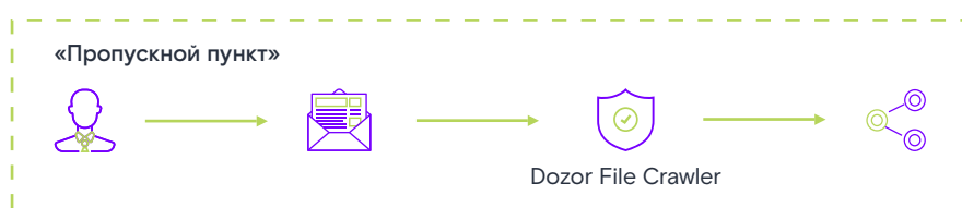
Рисунок 7. Схема работы активного краулера в качестве пропускного пункта
