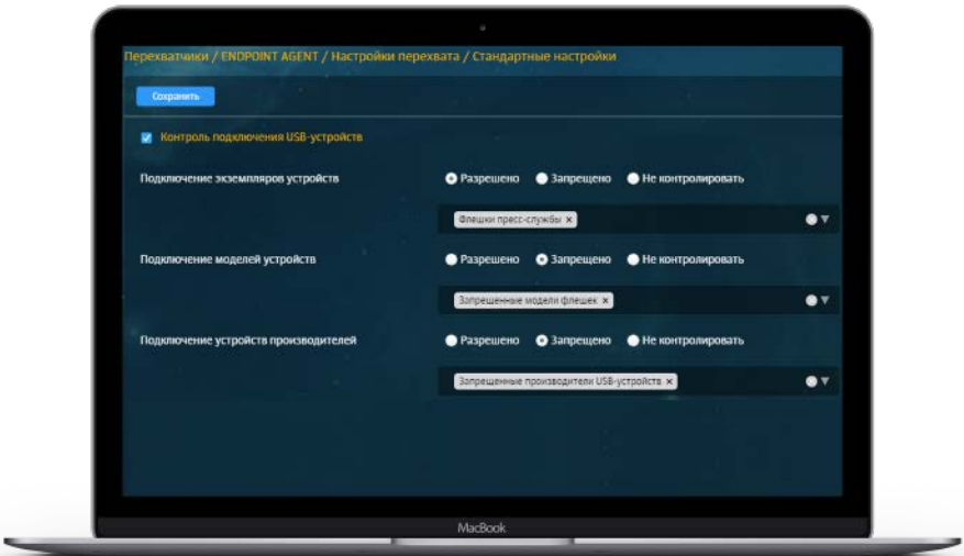
Рисунок 10. Настройки работы агента, параметры подключения USB-устройств: заданы устройства, которые разрешено/запрещено подключать к рабочим станциям
