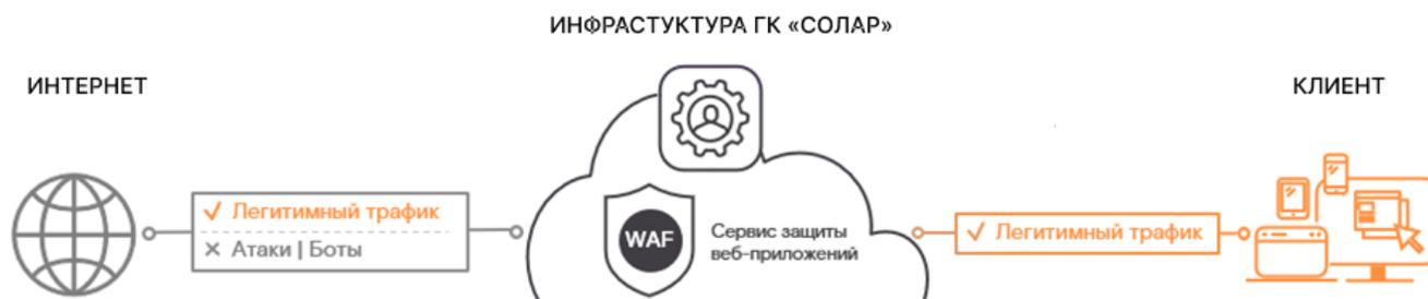
Рисунок 1. Схема подключения сервиса к инфраструктуре клиента
