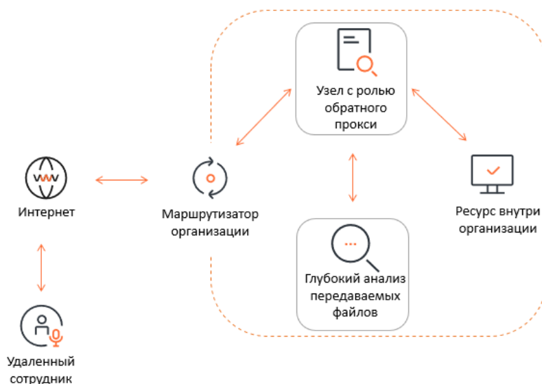
Рисунок 3. Solar webProxy в режиме обратного прокси-сервера
