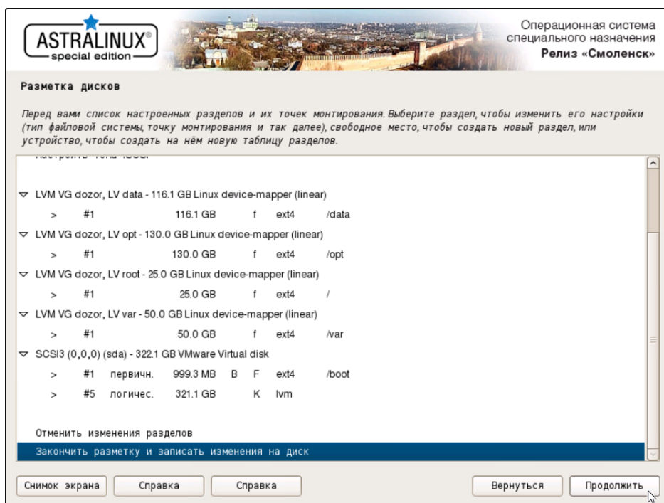
Рис. 4.31. Заполненные настройки томов для slave-узла
