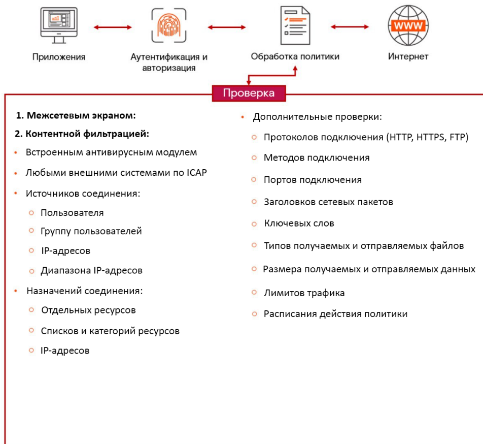
Рис. 2.1. Схема работы при подключении в разрыв потока
