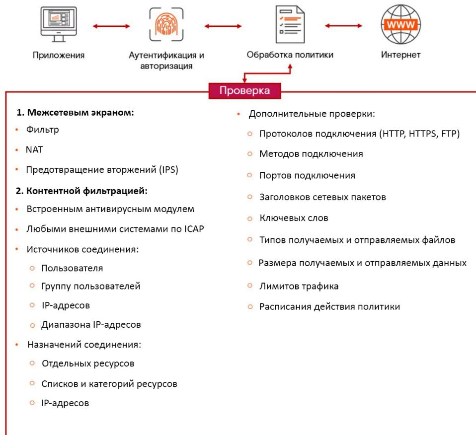
**Рис. 2.1. Схема работы при подключении в разрыв потока**
